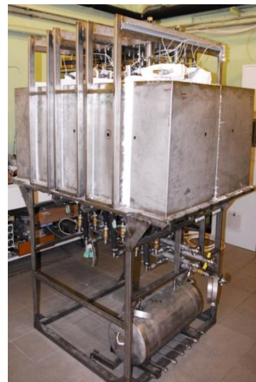
Общий вид батареи ЭХГ на 12 кВт ( H_2 ).
