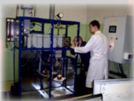
Пилотная установка по переработке кислых гудронов в жидкое топливо и битум
