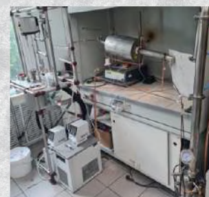
Установка для моделирования процессов образования отложений в технологии переработки нефти
