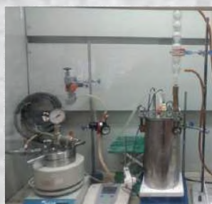
Установка нейтрализации щелочных промышленных стоков
